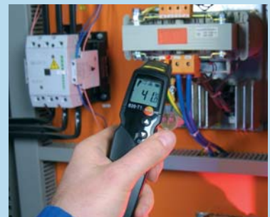
Označený měřený bod o velikosti 2 mm pro měření na povrchu s malým průměrem (testo 830-T3)
