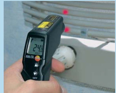
Spolehlivá měření díky zaměření laserovým paprskem
