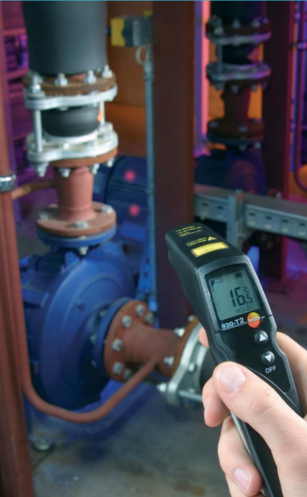
Spolehlivá měření díky zaměření laserovým paprskem
