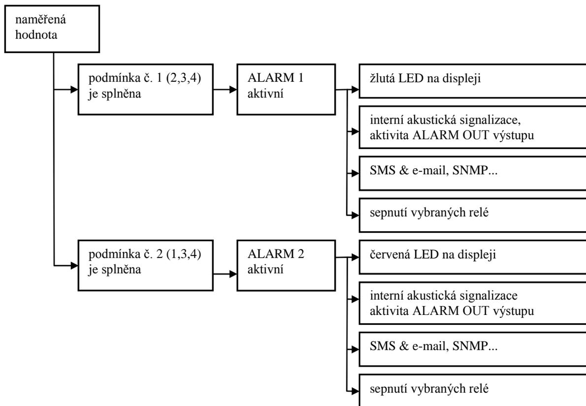
*Příklad vzniku alarmu při použití logické kombinace podmínek:*
