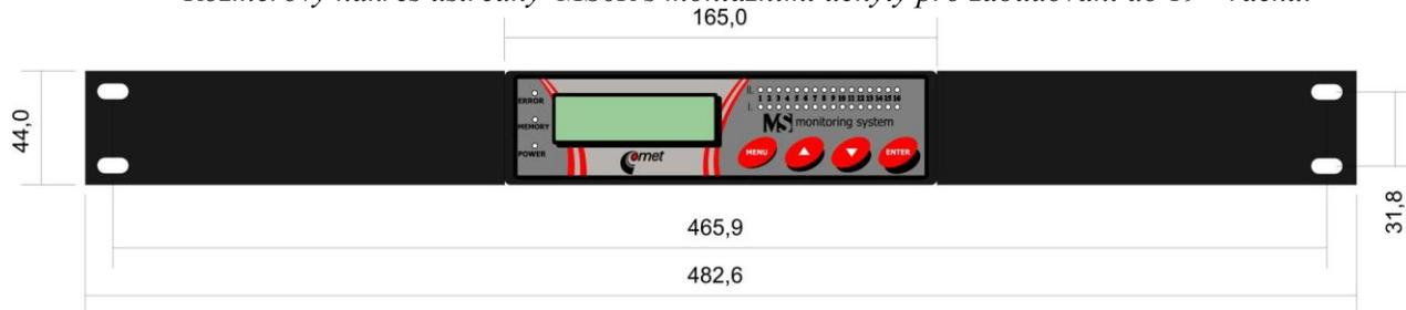
Rozměrový náčrt MS6D (bez kabelů a konektorů):
