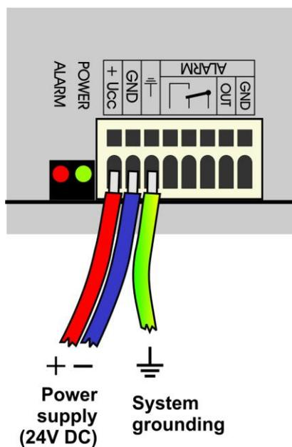
*Pokud systém není řádně uzemněn, hrozí stav, že bude plavat na proměnlivém potenciálu vůči všem ostatním obvodům, může docházet k výpadkům komunikace, občasným resetům a v extrémním případě může dojít i ke zničení některých periférií. Zejména při použití impulsních adaptérů (např. A1940) jednoznačně doporučujeme systém uzemnit.*
