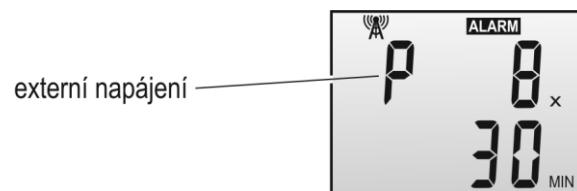
**P** (Power) – informace o přítomnosti externího napájení, je obnovována s intervalem 1 min.
