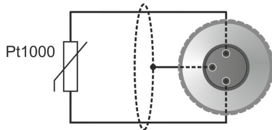
**Dodatek 2: Zapojení Cinch konektoru sondy řady Pt1000/C**
