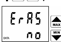
Přístroj dále nabízí možnost vymazání záznamové paměti (ERAS). Nemá-li být paměť před spuštěním záznamu vymazána, stačí potvrdit klávesou ENTER nabízenou volbu ERAS NO (nemazat).
