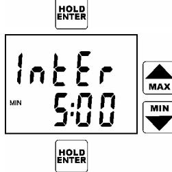
Nyní přístroj zobrazuje nastavený interval ukládání naměřených hodnot do paměti. Je-li třeba jej změnit, provede se nové nastavení klávesami se šipkami. Interval 10 sec je zobrazen jako **MIN 0:10**, minutové intervaly jsou zobrazeny **MIN x:00** a intervaly hodinové **x:Ho**. Nastavený interval se potvrdí kl. ENTER. Upozornění: je-li nastaven manuální typ záznamu, je tato položka přeskočena (interval se nenastavuje).
