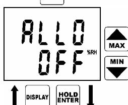
Přístroj dále nabízí nastavení alarmu další veličiny (relativní vlhkost). Postup nastavení alarmů všech veličin je zcela totožný s výše uvedeným nastavením alarmu teploty. Nebude-li alarm pro danou veličinu využíván, je možno jej vypnout nastavením dolní meze alarmu na její maximální nastaviteľnou hodnotu, jak je tomu v tomto případě. Číselná hodnota dolní meze alarmu se pak změní na nápis OFF.
