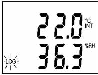
Záznam je spuštěn a přístroj se vrátí do režimu zobrazení hodnot měřených veličin. Spuštěný záznam je v tomto zobrazovacím režimu indikován na displeji rozsvíceným symbolem LOG. Je-li paměť už zaplněna nad 90 %, symbol LOG bliká (platí pouze pro automatický záznam).
