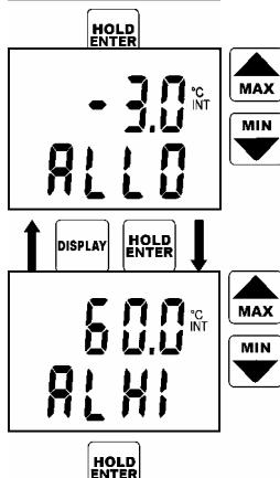
Nápis ALLO indikuje nastavovanou dolní mez alarmu, zde prostorové teploty. Klávesami se šipkami nahoru/dolů lze nastavit požadovanou hodnotu dolní meze. Přidržením klávesy nahoru (dolů) ve stisknuté poloze lze snadno opakovat (snižovat) nastavovanou hodnotu. Stiskem klávesy ENTER je nastavená hodnota dolní meze potvrzena.
