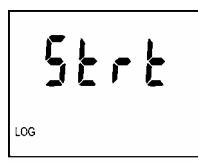
První nabídkou je START/STOP záznamu. Tato položka je ve dvou variantách: je-li záznam zastaven, nabízí se spuštění záznamu (symbol Strt = START), je-li naopak záznam už spuštěn, nabízí se zastavení záznamu (nápis STOP). Potvrzení (obou variant) této volby se provádí kl. ENTER. Upozornění: je-li indikována slabá baterie, nelze záznam spustit.
