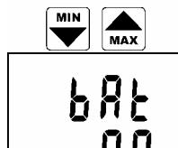
Zobrazuje se orientační hodnota napětí částečně zatížené baterie. Z této hodnoty lze posoudit stav baterie.
