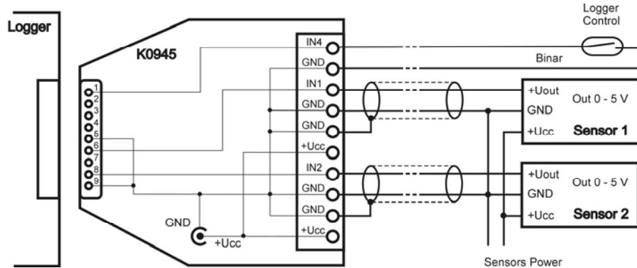
*Připojení záznamníku ke snímačům. Napájecí zdroj snímačů umístěn v místě záznamníku*
