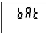
Zobrazuje-li se periodicky nápis BAT na horním řádku displeje (vždy na 1 s s intervalom 10 s), je tímto indikováno ukončení předpokládané životnosti baterie – přístroj je však nadále funkční v plném rozsahu. Baterii je vhodné co nejdříve vyměnit!
