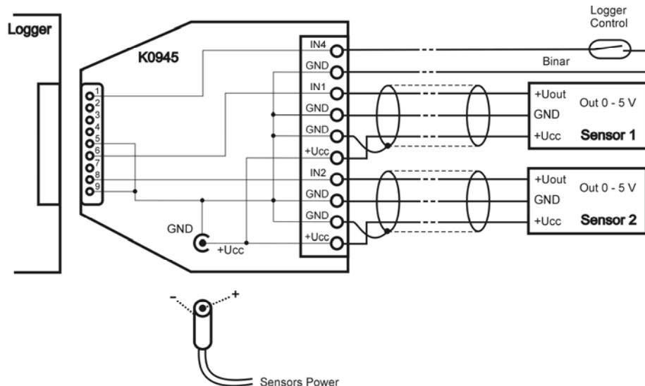
V tomto případě je možné snímače napájet např. ze síťového adaptéru, připojeného přes souosý napájecí konektor k adaptéru K0945. Velikost napájecího napětí a výkon použitého síťového adaptéra závisí na typu použitých snímačů.
