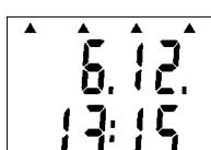
Došlo-li od posledního nastavení času ve vnitřních hodinách záznamníku k poklesu napětí baterie pod kritickou mez nebo k jejímu odpojení na dobu delší než cca 30 s, rozsvítí se po jeho zapnutí (při zobrazení data a času) na displeji všechny čtyři šipky jako varování, že čas v záznamníku nemusí být správný a musí být znova z počítače nastaven. Všechny funkce záznamníku však pracují bez omezení.
