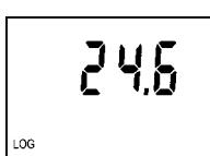
**Je-li zapnut displej**, následuje zobrazení naměřených hodnot. Symbol LOG indikuje probíhající záznam – jestliže bliká, je paměť naměřených hodnot zaplněna více než z 90%.
