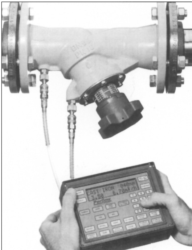
Měřicí přístroj č. vyr. 106 91 60 připojený na ventil "Hydrocontrol F" DN 65.
