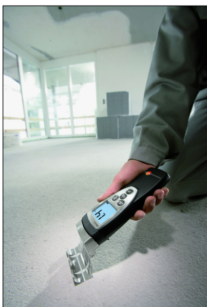
Měření vlhkosti potěru
