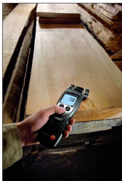
Měření vlhkosti dřeva
