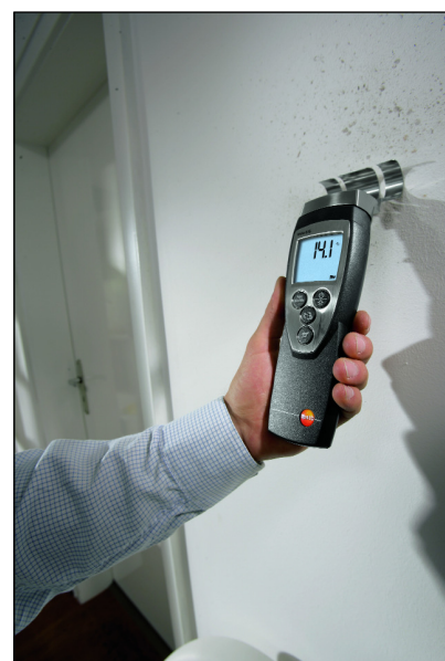
Měření vlhkosti zdiva
